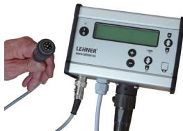
1. Verbindungskabel des Steuerpults mit der 7-poligen Signalsteckdose des Traktors verbinden.
